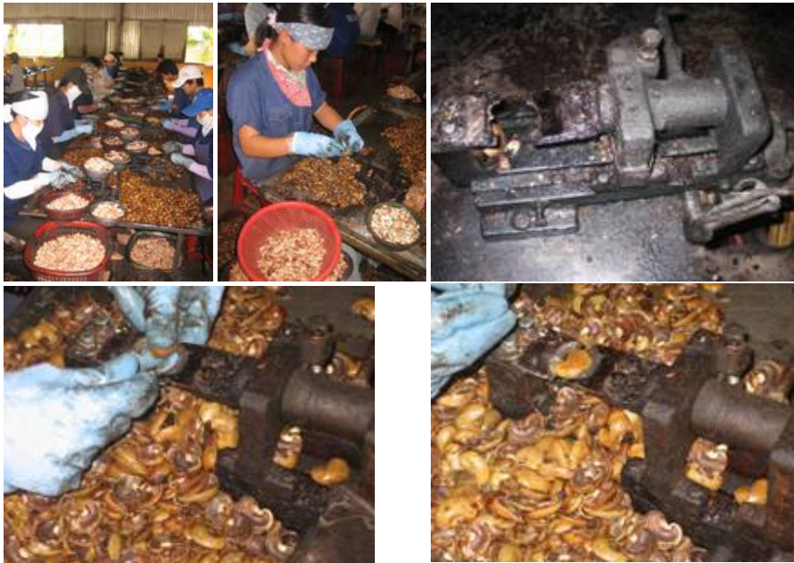
Ảnh 15 Tách vỏ và các chi tiết thiết bị tách vỏ
