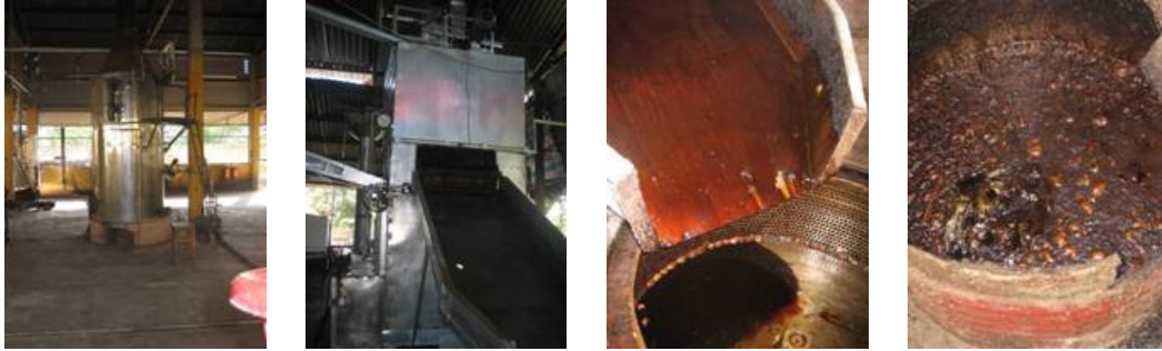
Ảnh 14 Máy hấp và chao dầu, dầu còn lại và dầu thoát ra (từ trái sang phải)
